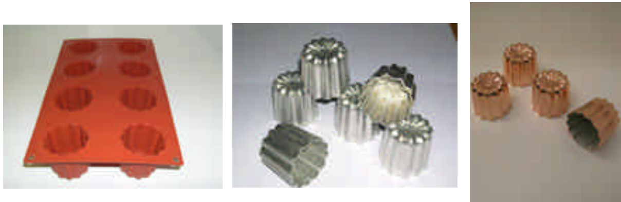
Figure 8 : Différents moules testés : (de gauche à droite) moules en silicone, moules en aluminium, moules en cuivre étamé.
